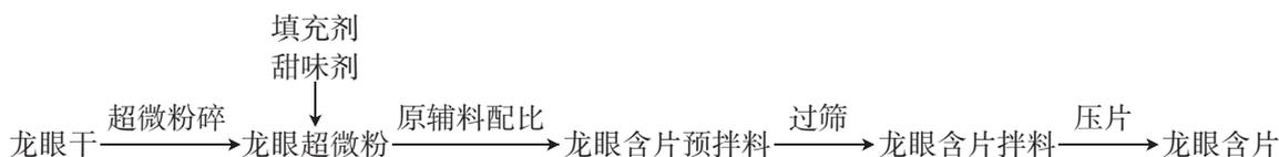
图1 龙眼超微粉含片制备工艺流程
